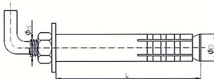
Rysunek A2. Stalowy łącznik jednorozporowy SLL
